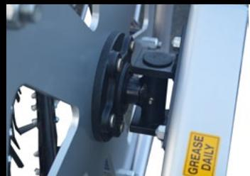
SELF-ALIGNING IDLER HUBS
