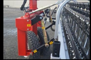
PARALLEL LINKAGE TORSION BASKET SUSPENSION
